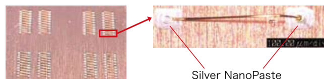
図6: ナノペーストによって形成した銀パッドへの金ワイヤ接合試験
