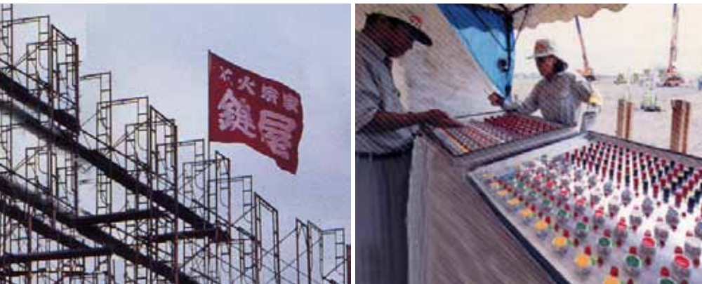
写真上段：大量の火薬をワイヤーで山型に高く吊るし、一斉に点火。火の粉がさらさらと流れ落ち、富士山が浮かび上がる。下段左：鍵屋の旗はためく、仕掛け花火の現場。仕掛け花火は、ロープ・ワイヤーに焰管（ランス）を文字や絵の形に組み立て、点火する。下段右：鍵屋が開発した電気点火器。打ち上げ場の周辺数百メートルに人の姿はない。©Kazutoshi Murata
