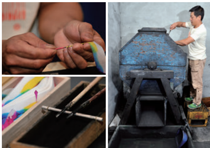
左上、火薬を入れこより状に纏っていく。ベテランになると1本約10秒。左下、火薬を量るお手製のさじと火薬箱。右、100年以上使われている配合機。
