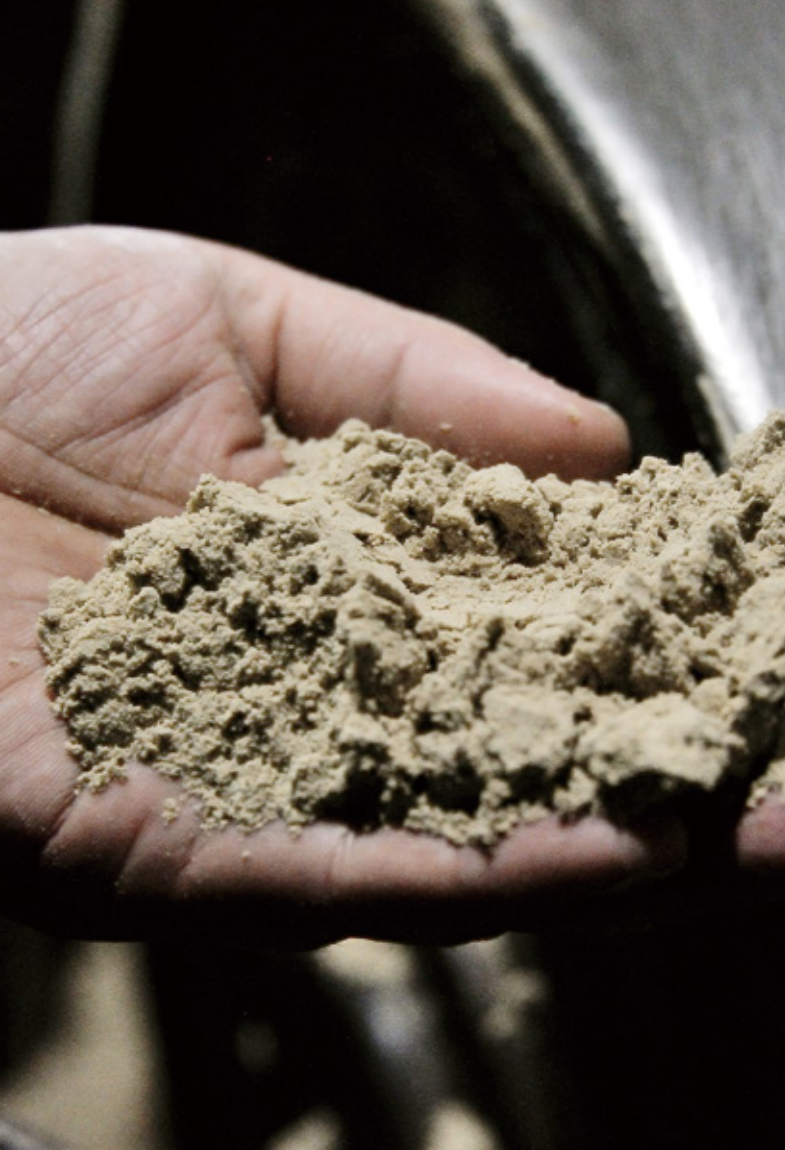
写真左、砂の細かさと湿り具合は各社で異なる。及源鑄造で使っているのは栃木県日光産の山砂。写真右は、鉄瓶の外型の型づくりをしている鉄瓶職人の小野さん。和紙に描いた下絵をもとにして、ヘラで押して模様をつける。
