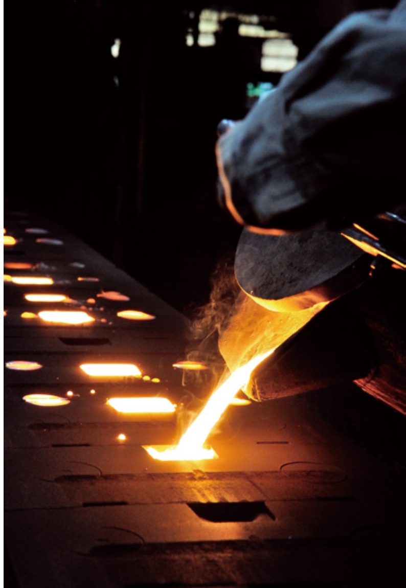
写真左は湯（高温で溶けた鉄）を型の上部に空いた穴に流す瞬間。商品に「まあいいか」の妥協はない。女性社員の厳しいチェックを通ったものだけを出荷する。写真右は笑顔の及川久仁子さんと中央に、工場で働く皆さん。
