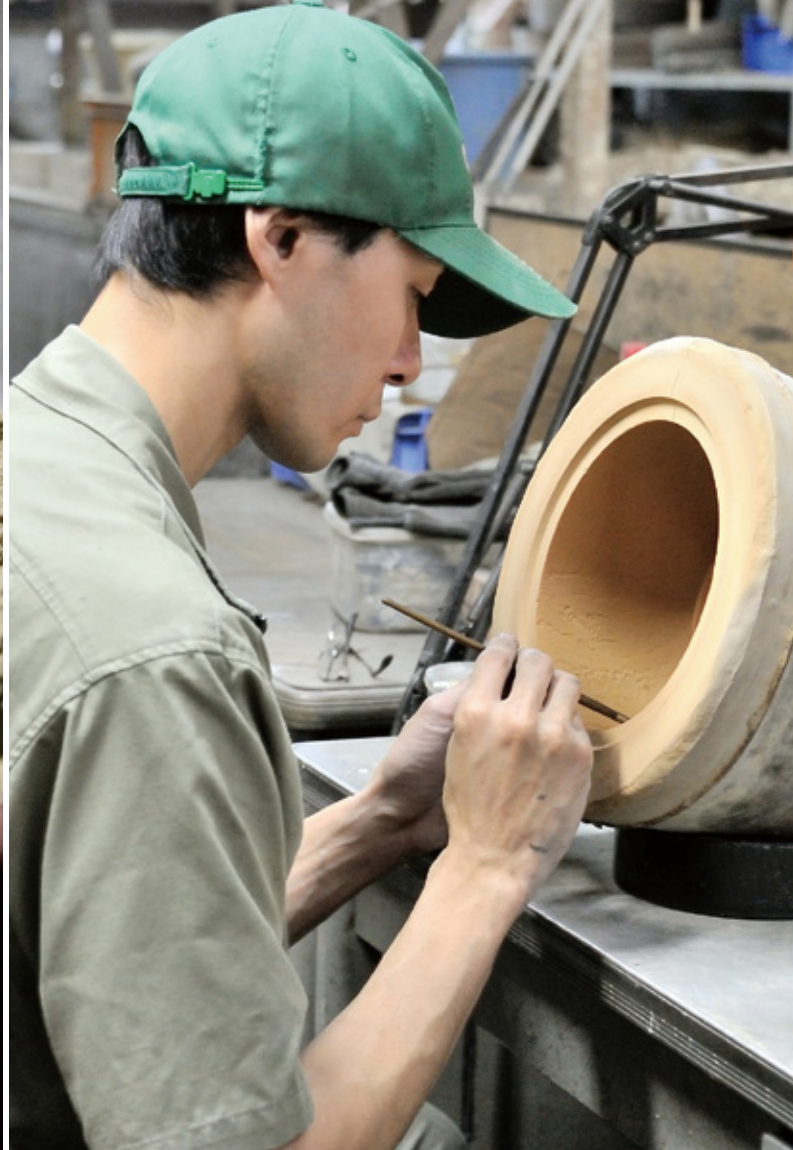
写真左、砂の細かさと湿り具合は各社で異なる。及源鑄造で使っているのは栃木県日光産の山砂。写真右は、鉄瓶の外型の型づくりをしている鉄瓶職人の小野さん。和紙に描いた下絵をもとにして、ヘラで押して模様をつける。
