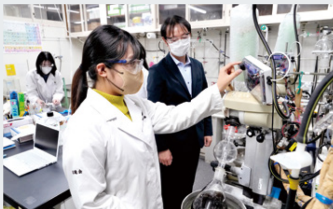
圧力調整器付きのロータリーエバポレーターを使って溶媒を留去している
