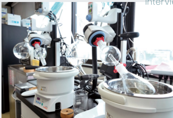
有機化合物を反応させた後に、溶媒を留去するためのエバポレーター
