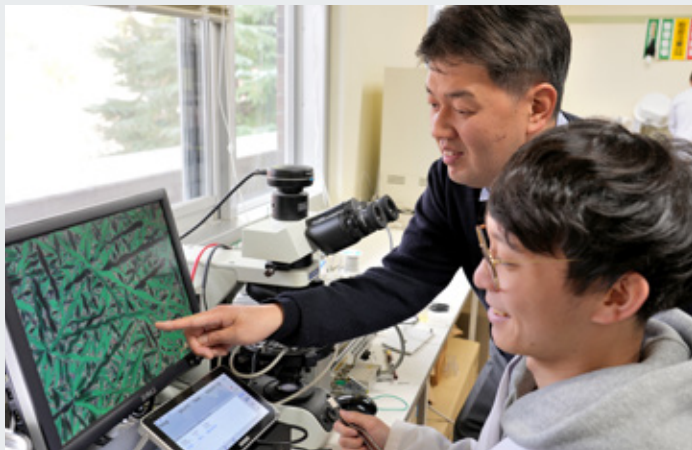
偏光顕微鏡を用いて液晶相の配列状態を観察し、得られた画像を見ながら学生と議論することも
