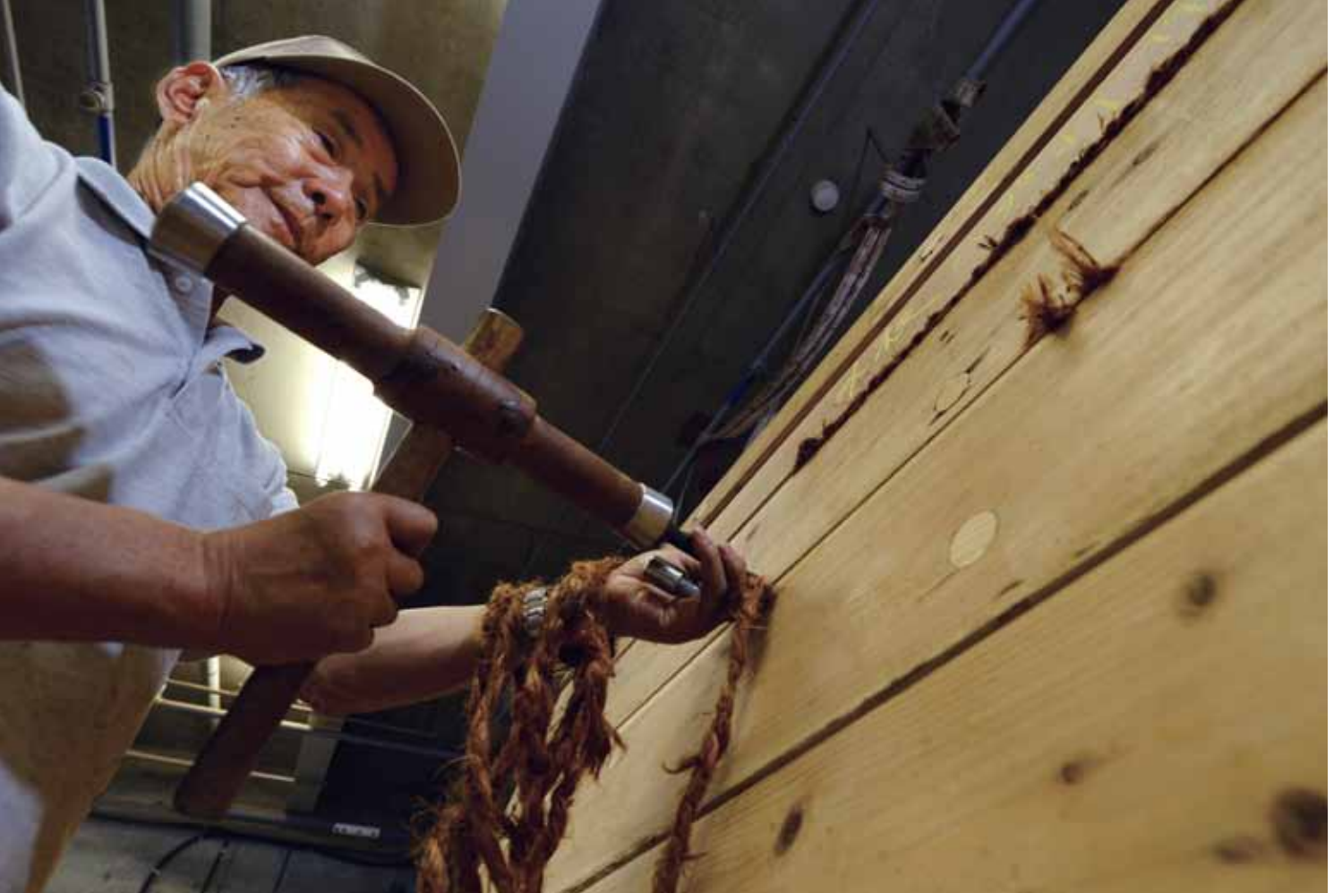
板と板の隙間に绳を入れていく「ハダ打ち」。隙間によって入れ方を微妙に加減する。
