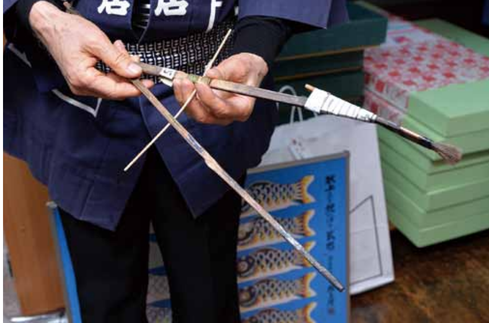
(写真左上) 色付け用の顔料。(左下) 左は金の文様を描く金引き用の筆。右は先代から使っている刷毛。(右) 鯉の目を描く目廻し(めまわし)用の手製のコンパス。目の大きさは鯉の大きさに比例して決められている。
