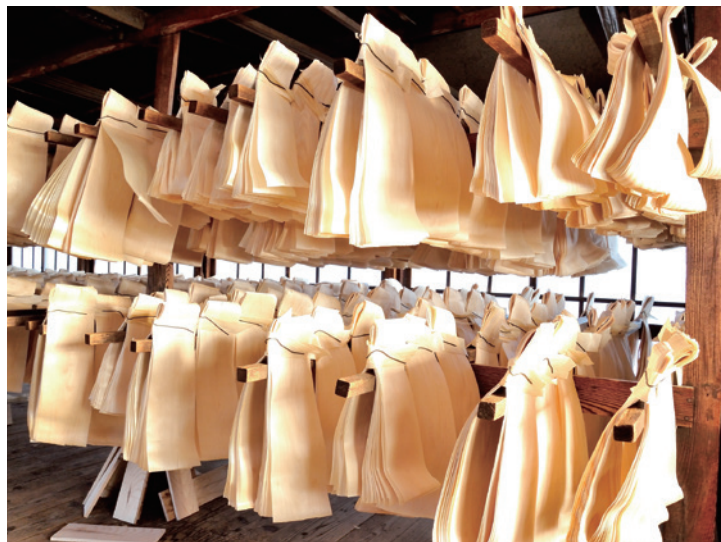
建屋の2階で自然乾燥。冬はボイラーをたいて温めて乾燥させる。
