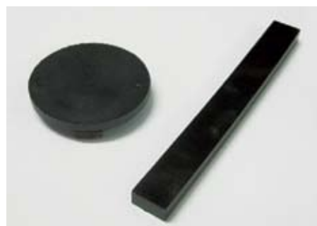
図5：当社リグニンを添加した樹脂成形品(大阪市立工業研究所にて作製)
