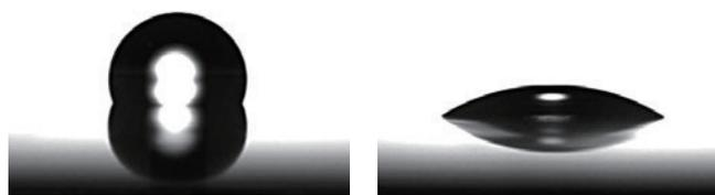
図1 撥水性表面と親水性表面上の水 droplet 状態
