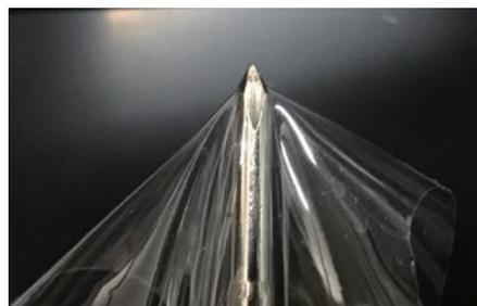
図9 キズ復元コート剤を塗布した保護シート例
