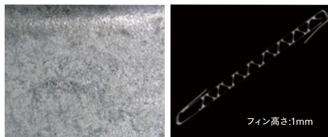
図13 ろう付け後外観とフィン接合時のフィレット形成の様子(ハリマ試作品)
