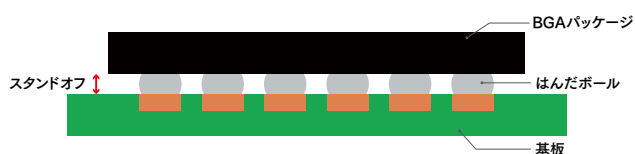
図5 低スタンドオフ部品 (BGA) 模式図
