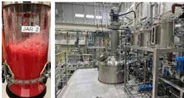
図7 ラボスケール評価培養とGEIでの3,000Lスケール培養槽
